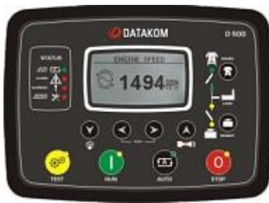
D500 je univerzalni genset kontroler za najrazličitije konfiguracije sa jednim agregatom. Moguće su sledeće konfiguracije kontrolera:
